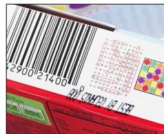
Nieczytelne i nieprawidłowo umieszczone oznakowanie
